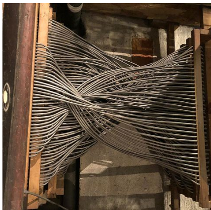
Pneumatische Traktur zwischen Spieltisch und Orgel
