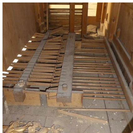
Hinten die Pedalklavatur im Unterbau, dabbb die Pedaltraktur, zuvorderst im Bild Teil der abgefallenen Schnitzereien
