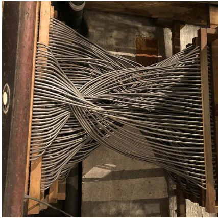
Pneumatische Traktur zwischen Spieltisch und Orgel
