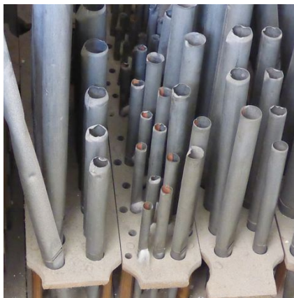
Mixtur: ein fehlender Chor und zwei abgesteckte Reihen. Also "klingt" momentan nur ein Chor
